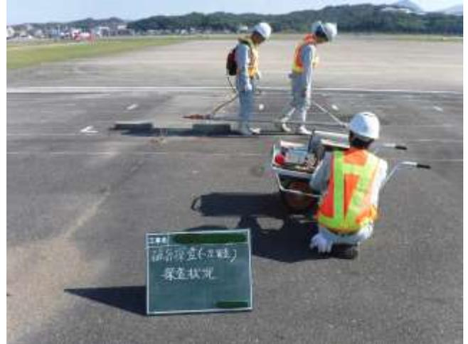
地表で磁気探査機を移動させて磁気異常を測定し、記録します。
