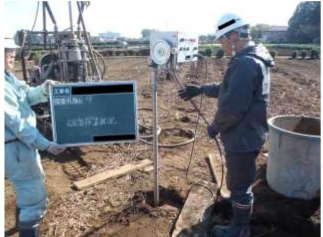
ボーリングマシンにより探査孔を削孔し、その孔内に磁気センサをいれて地下深い部分の探査を行います。
